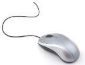
O mouse é um periférico indicador (em inglês pointing device) que serve para deslocar um cursor na tela, permitindo seleccionar, mover, manipular objetos graças a botões. Chama-se "clique", a ação de pressionar (clicar) um botão para efetuar uma ação.
