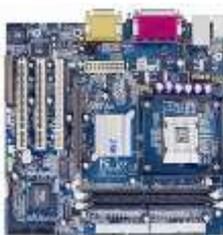
A placa mãe é a parte do computador responsável por conectar e interligar todos os componentes do computador entre si, ou seja, processador com memória RAM, disco rígido, entre outros. É nela que são conectados todos estes componentes. Existem alguns padrões de placas mãe, cada qual com seu tamanho específico e quantidade de barramentos e conectores.
