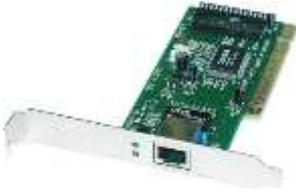
A placa de rede é o hardware que permite aos computadores conversarem entre si através da rede. A sua função é controlar todo o envio e recepção de dados através da rede.
