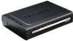
Modem é junção das palavras: modulador e demodulador. Ele é um dispositivo eletrônico que modula um sinal digital em uma onda analógica, pronta a ser transmitida pela linha telefônica, e que demodula o sinal analógico e o reconverte para o formato digital original. Utilizado para conexão à Internet, BBS, ou a outro computador.
