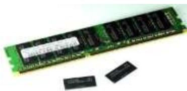
A memória RAM é uma memória temporária para armazenar dados e parte dos softwares que estão em execução. Ela é uma memória que apenas armazena informações quando o computador está ligado, pois armazena esses dados em componentes eletrônicos - como o Flip-Flop ou Capacitores - que necessitam de energia elétrica para funcionar. Dessa forma, o processador usa a memória para armazenar as informações que ele estiver usando para trabalhar no momento.
